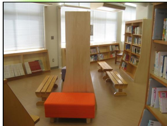
斜めにすることで、窓下の書架も見やすくなり、座るスペースも増えた。
